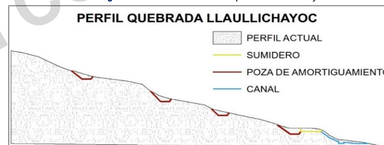
Imagen N° 56: Canalización de la quebrada Llaulichayoc
