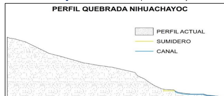
Imagen N° 57: Canalización de la quebrada Nihuachayoc.
